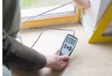
Mesure de la vitesse de l'air avec un anémomètre
