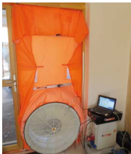
La « porte soufflante » permettant de mettre le bâtiment en dépression
